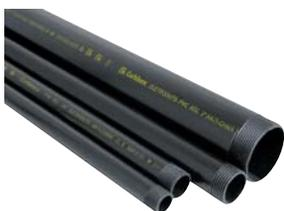
Eletródutos Rígidos e Conexões Roscáveis em PVC aplicados em instalações elétricas residenciais, comerciais e industriais de baixa tensão. Norma NBR 15.465 Classe B, antichama em barras com 3 metros. Diâmetros variando de 1/2" a 4". Curvas e luvas são fabricadas nos ângulos de 45°, 90°, 135° e 180°.
